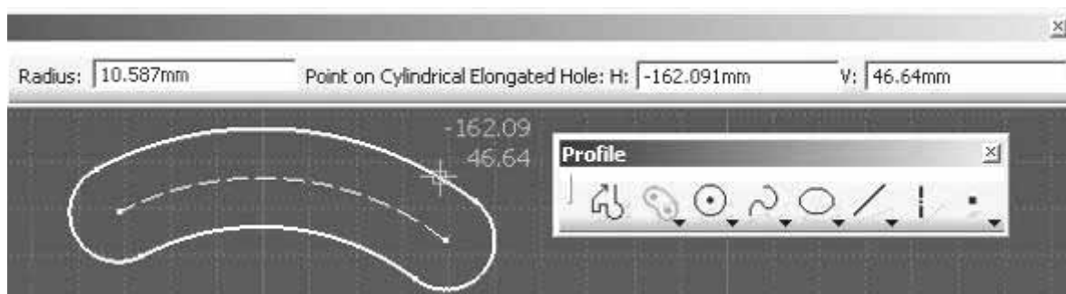
Fig. 2.17. Trasarea unei găuri alungite curbate
