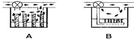
Fig. 15.17 Posibilități tehnice de mărirea suprafeței de vaporizare. A-mese, B-bronz sau sticlă sinterizată.
