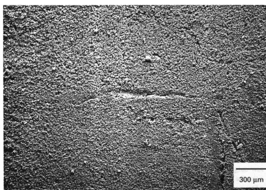
**Fig. 6.51** Micrografia electronică a hidroxiapatitei depusă pe aliajul Ti6Mn cu un agent de legare și tratată la 1200 °C.
