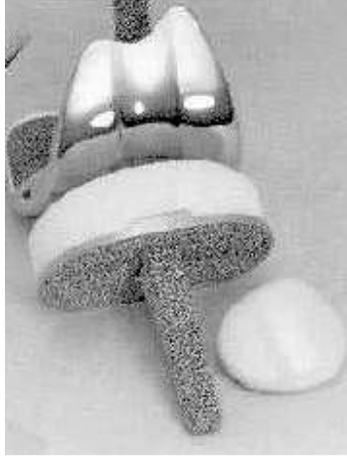
**Fig. 6.89** *Acoperiri superficiale poroase pe componentele implantabile ale protezei de genunchi*
