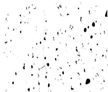
**Fig.5.18** *Microstructura aliajului Co-Cr-Mo turnat (netratat)*
