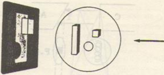
Fig. 15. Efectul de sumație a planurilor. La marginile paralelipipedului, cubul, reprezentând un corp dens, produce un surplus de opacitate, în timp ce sfera cu conținut aeric realizează prin substracție o zonă mai transparentă.
