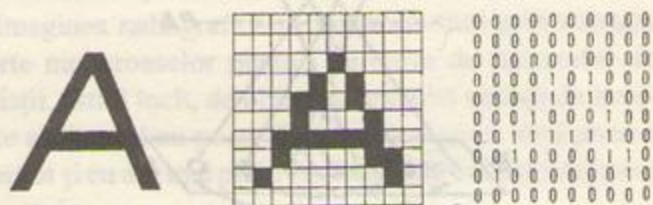
Fig.31. Transcriere digitală a unei imagini alb-negru. Peste imaginea originală analogică a literei (care nu are nuanțe intermediare), este aplicată o matrice 10 x 10 care o descompune în 100 de elemente (b). Albului i se atribuie valoarea 0 iar negrului valoarea 1. În transcrierea digitală (c), treptele de luminozitate ale fiecăruia din elementele matriciale pot fi exprimate cu 1 bit, respectiv prin 0 sau 1.
