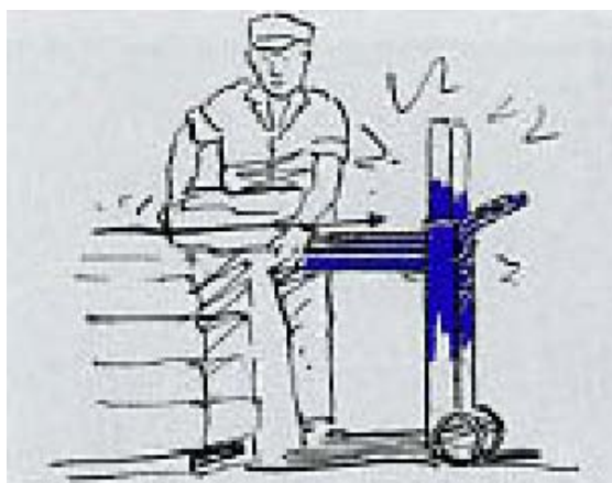
Folosirea unui lift hidraulic, reduce efortul folosit pentru ridicarea greutăților; poate avea rol și ca platformă.
