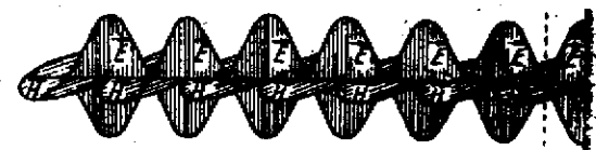
Fig. 48. Undă electromagnetică staționară: nodurile și ventrele vectorului \vec{E} sînt deplasate cu un sfert de lungime de undă față de nodurile și ventrele vectorului \vec{H} .
