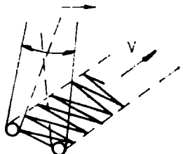
Fig. 6.13. Ilustrarea principiului de tratament termic cu fascicul oscilant.
