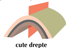
▲ Fig. 38 Cutarea stratelor de roci a) strat orizontal; b) strat cutat, elementele cutoiei
