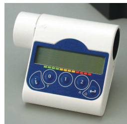
Fig. 3.16. Spirometru – aparat pentru măsurarea volumului de aer respirat.
