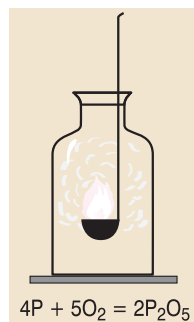
Fig. 2.5. Reacția de combinare dintre fosfor și oxigen.
