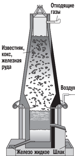
Рис. 7.4. Получение чугуна в доменной печи
