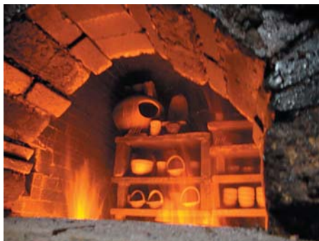
Cuptor de copt (tratate termică) ceramică.
