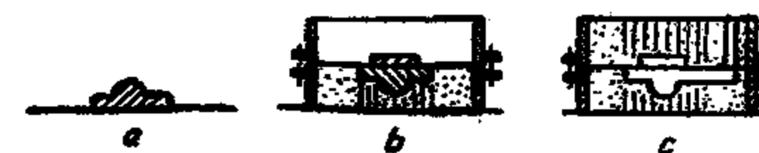
Fig. 76. Executarea formei de turnare.
