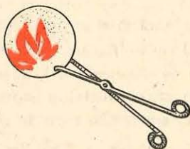
Fig. 4.31. Aprinderea hîrtiei de filtru îmbibate cu soluție de fosfor alb în sulfură de carbon
