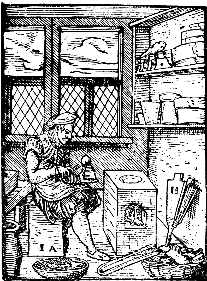
Fig. 6. — Turnător de litere varsă plumb în matrița topitoarei. În coș, în stînga, se văd literele vărsate ce trebuie piliate înainte de folosire. Xilografie de Jost Druman în cartea Beschrybung aller Stünde , din 1568, cu versuri de Hans Sachs. Apud Svend Dahl, Histoire du livre , Paris, 1961, fig. 33
