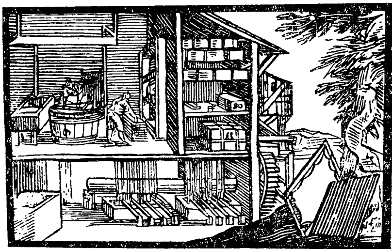
Fig. 11 — Moară de hirtie germană. La parter, apa învîrtește roata care pune în mișcare maiurile de bătut, și cirpele sînt pisate pînă se fac cocă moale. Aceasta e supusă la alte lucrări în cada din primul etaj. După Armin Renker, Das Buch vom Papier , Leipzig, 1951. Apud Svend Dahl, Histoire du livre , Paris, 1961, fig. 27
