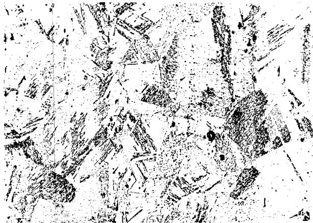
Figure 4. — Micrographie de la zone localement transformée de l'éprouvette d'acier inoxydable n° 2 : (a) près de la surface, (b) à cœur.
