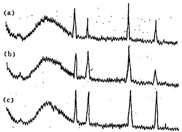
图 1 Ag 的 X 衍射分析曲线 (a)对照 (b)剩余 (c)取出
