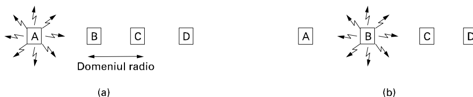
Fig. 4-11. Un LAN fără fir. (a) A transmite. (b) B transmite.
